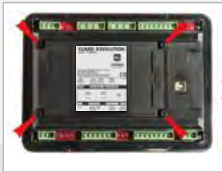
KLEMMEN NACH UNTEN DRÜCKEN, UM DEN SCHUTZDECKEL ZU ENTFERNEN
