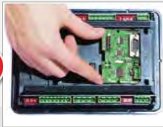
DAS ERWEITERUNGSMODUL IN EINEN DER BEIDEN SLOTS EINSETZEN
